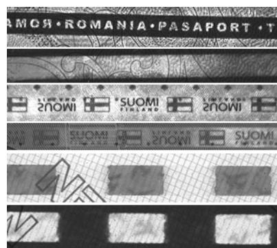
**Slika 2.** Zaštitne niti s mikrotiskom i pripadajućim UV zaštitnim svojstvima i to: metalizirana (gore), transparentna (sredina), te s difraktivno optičkim svojstvima (dolje)
