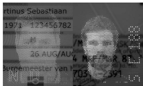
**Slika 8.** Laserski perforirana sekundarna fotografija (ImagePerf®) u transmisijskom području zračenja na ID stranici nizozemske putovnice (lijevo) te švedske putovnice (desno)
