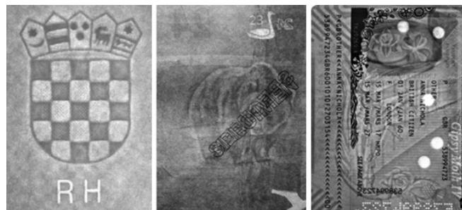
**Slika 1.** Jednotonski i *electrotype* vodeni znak u papiru hrvatske putovnice (lijevo), jednotonski i višetonski vodeni znak u papiru finske putovnice (sredina), te jednotonski, višetonski, SkyLight™ Cornerstone® te Edgestone™ vodeni znak u papiru britanske putovnice (desno)
