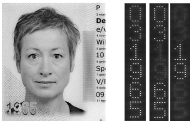
**Slika 11.** TLI<sup>®</sup> u VIS području zračenja (lijevo) te uvećanog detalja u transmisiskom području zračenja na ID stranici nizozemske putovnice (desno)
